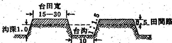
图 74 沟漕台田断面示意图(单位:米)
