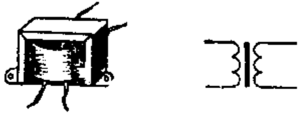
图 2-4-2 输出变压器及其符号
